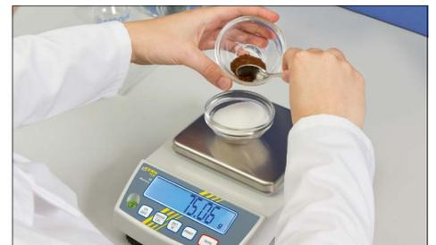
Mit der **Rezepturfunktion** lassen sich verschiedene Bestandteile einer Mischung zuwiegen. Zur Kontrolle kann das Gesamtgewicht aller Bestandteile aufgerufen werden
