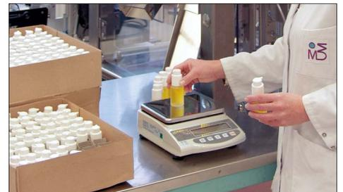
**Wägen mit Toleranzbereich (Checkweighing):** ein optisches Signal unterstützt das Portionieren, Dosieren oder Sortieren
