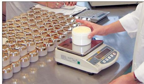
**Prozentbestimmung:** ermöglicht das Einwägen auf einen vorgegebenen Wert (100%) und das Feststellen von Abweichungen von diesem Sollwert
