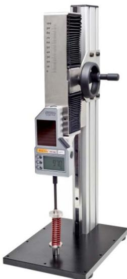
Digitale Kraftmessgeräte der Baureihe FMI-S20 mit solarer Energieversorgung können als Handmessgerät in der Qualitätsüberwachung oder Produktprüfung genutzt werden oder auch in Prüfeinrichtungen fest eingebaut werden. Bohrungen auf der Rückseite und seitliche M10-Gewinde ermöglichen die Anbringung von Handgriffen oder die präzise Ausrichtung der Geräte im Prüfstand.
