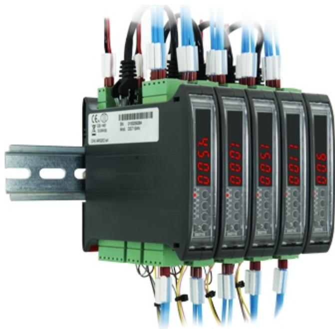
Multifunktionaler Gewichtsmessumformer zur Befestigung auf einer C-Schiene (DIN). Ermöglicht die direkte Abfrage und Diagnose jeder angeschlossenen Wägesystem. Die Vielfalt der verfügbaren Schnittstellen ermöglicht eine einfachere und sichere Integration von Wiegensystemen an jedes Automatisierungssystem. CE-M eichfähig (OIML R-76 / EN 45501). MID eichfähig (OIML R-61).
