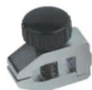
**AC-14: Kleinklammeraufsatz**, bis max. 500 N Zugkraft, Spannbreite 16 mm, Spanntiefe 4 mm über Rändelschraube, geriffelte Spannfläche, Aufnahmebohrung M6, geeignet für Zug- und Einsteckversuche von elektronischen Bauteilen, Zylinderstiften, Steckverbindungen
