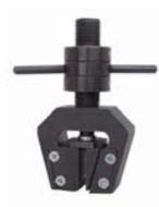
**AC-04: Flachklammeraufsatz**, bis max. 5000 N Zugkraft, Spannbreite 30 mm, Spanntiefe 6 mm über Spannkeil, Aufnahmebohrung M10, Spannfläche geriffelt, geeignet für Zugproben mit hoher Spannkraft, z.B. für glatte Oberflächen oder weiche Materialien (Holz)
