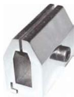
**AC-03: Flachbackenaufsatz**, bis max. 5000 N Zugkraft, Spannbreite 50 mm, Spanntiefe 3 mm über Innensechskantschraube, Aufnahmebohrung M6, Spannfläche geriffelt, geeignet für Zugproben von Kunststoffen, Textil, Papier, etc.
