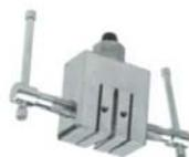
**AC-12: Backenklemmenaufsatz**, bis max. 5000 N Zugkraft, Spannbreite 25 mm, Spanntiefe 5 mm über Spannhebel, geriffelte Spannfläche, Aufnahmedorn M10, geeignet für Zugversuche von Kunststoffen
