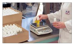
Wägen mit Toleranzbereich (Checkweighing): ein optisches Signal unterstützt das Portionieren, Dosieren oder Sortieren
