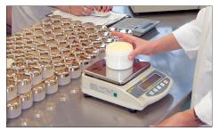
**Prozentbestimmung:** ermöglicht das Einwägen auf einen vorgegebenen Wert (100%) und das Feststellen von Abweichungen von diesem Sollwert
