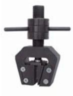
**AC-04: Flachklammeraufsatz**, bis max. 5000 N Zugkraft, Spannbreite 30 mm, Spanntiefe 6 mm über Spannkeil, Aufnahmebohrung M10, Spannfläche geriffelt, geeignet für Zugproben mit hoher Spannkraft, z.B. für glatte Oberflächen oder weiche Materialien (Holz)
