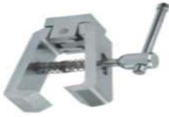
**AC-01: Spitzklammeraufsatz**, bis max. 500 N Zugkraft, Spannbreite 20 mm, Spanntiefe 15 mm über Spannhebel, Aufnahmebohrung M6, geeignet zum abziehen div. Bauteile, z.B. Zahnräder, Umlenkrollen, Taster, Kabelverbindungen etc.
