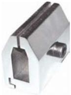
**AC-03: Flachbackenaufsatz**, bis max. 5000 N Zugkraft, Spannbreite 50 mm, Spanntiefe 3 mm über Innensechskantschraube, Aufnahmebohrung M6, Spannfläche geriffelt, geeignet für Zugproben von Kunststoffen, Textil, Papier, etc.
