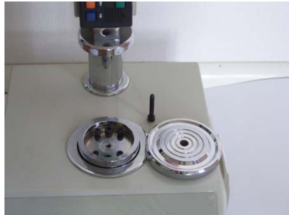
c. Zugständer auf Sockel setzen und Grundplatte auf Zugständer anbringen
