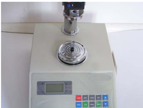
b. Grundplatte vom Sockel abnehmen
