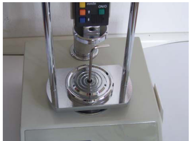
e. Langer Schraubgriff (1.) in Oberseite des Zugständers von oben einführen
